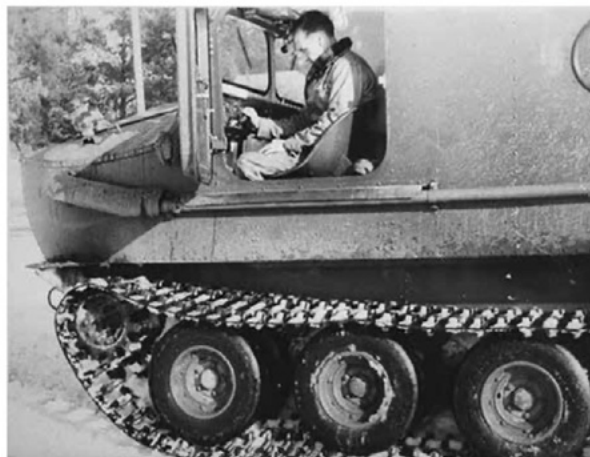
Een T46E1 wordt van zijn transportoplegger ontkoppeld om klaar te maken voor sneeuwtests (▼). Duidelijk zichtbaar is de uitlaat langs de buitenkant. In de productieversie werd de uitlaat binnendoor naar boven geleid. Ook is hier goed te zien dat de T46E1 een ander rups- en loopwiel configuratie had. Iets dat later op productiemodellen is toegepast. Daarbij is het laatste loopwiel vervangen door een spanwiel die ook hoger van de grond geplaatst was.
