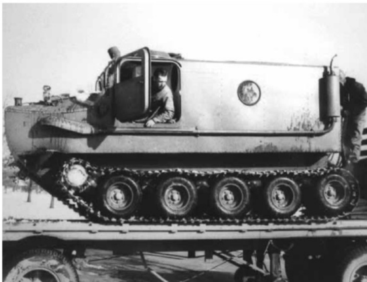
Een T46E1 wordt van zijn transportoplegger ontkoppeld om klaar te maken voor sneeuwtests (▼). Duidelijk zichtbaar is de uitlaat langs de buitenkant. In de productieversie werd de uitlaat binnendoor naar boven geleid. Ook is hier goed te zien dat de T46E1 een ander rups- en loopwiel configuratie had. Iets dat later op productiemodellen is toegepast. Daarbij is het laatste loopwiel vervangen door een spanwiel die ook hoger van de grond geplaatst was.
